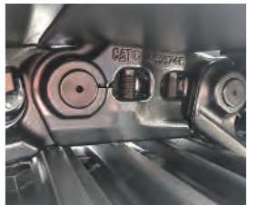
従来の圧入式ジョイントに比べ、 ピンの保持力を25%アップ。
