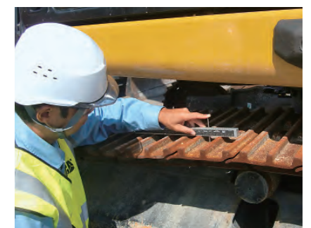
足回り部品の使用状況を点検・計測して摩耗率を予測し、適切なメンテナンスをアドバイス。
