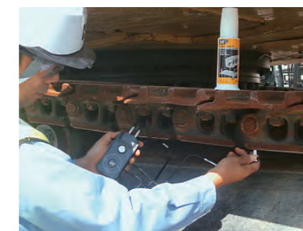
足回り部品の使用状況を点検・計測して摩耗率を予測し、適切なメンテナンスをアドバイス。
