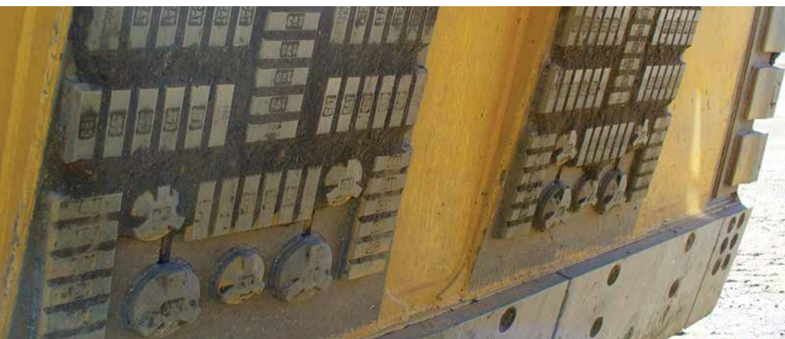
Barras de calço em aplicação
