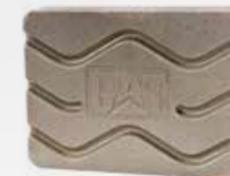
**Blocos de Desgaste** têm um projeto de inserção em ziguezague que permite o desgaste de material-sobre-material. Eles evitam o desgaste de canal comum em sulcos paralelos, entregando vida útil estendida em operações extremas.
