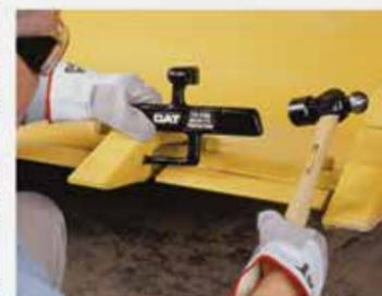
**3** Coloque a ferramenta sobre a ponta (A), posicione o pino no furo do suporte (B) e bata com a ferramenta (C).
