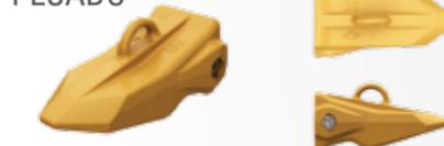
» Las puntas de penetración de servicio pesado son ideales para los materiales de alto impacto y difíciles de penetrar. Tienen aproximadamente 120 % más de material de desgaste en el área de mucho desgaste así como también tienen un diseño de pala afilada con 70 % menos de área transversal en la cuchilla delantera que las puntas de abrasión de servicio pesado.
