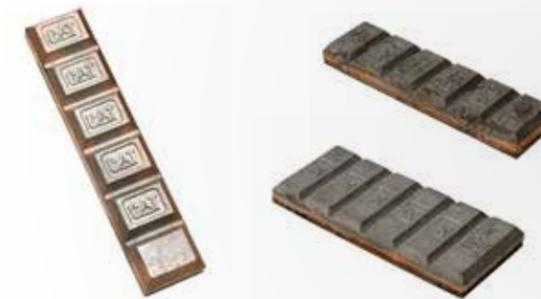
**Las barras de protección**, disponibles en cuatro formas, tienen un diseño ranurado en V que se puede adaptar alrededor de un radio. Se pueden separar y su longitud se puede modificar. La inserción del logotipo de Cat permite recoger el material fino en cada sección, lo que extiende la vida útil del material de desgaste mismo. Las barras de protección vienen en cuatro tamaños.
