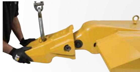
**2** Deslice la punta en el adaptador.
