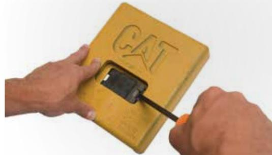
**4** Limpie y utilice una barra dislocadora para quitar el retenedor de compresión y deslice la placa de desgaste por retirarla de la plancha de base.
