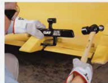
**3** Coloque la herramienta en la punta (A), ubique el pasador en el orificio del portador (B) y golpee la herramienta (C).
