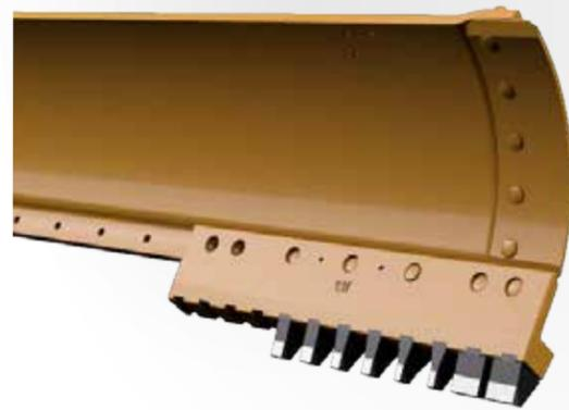
**4** Mantenga las puntas de forma perpendicular a la superficie del camino. El ángulo de alineación no debe superar los 10°, profundidad de penetración de 1 1/2" como máximo, y 6 mph (10 km/h) como máximo.
