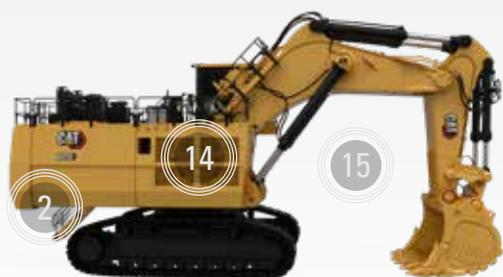
1. Bastidor de oruga y tren de rodaje Cat® nuevos con rodillos HD (Heavy Duty, servicio pesado), ruedas guía HD, cadena HD y sistema de tensión de cadena.
