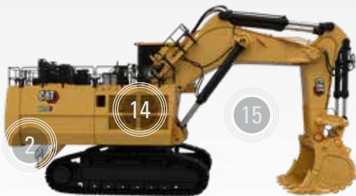
1. Nouveau châssis des chaînes et train de roulement Cat® avec galets usage intensif, roues folles usage intensif, chaîne usage intensif et tension des chaînes.
