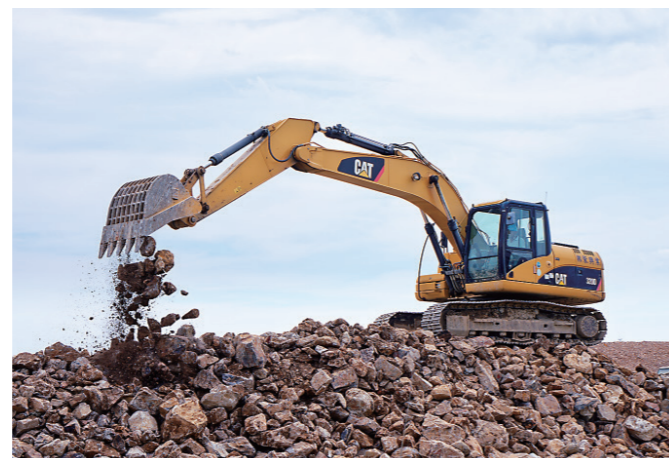
スケルトンバケットを装着して粒径処理を行う320D。
