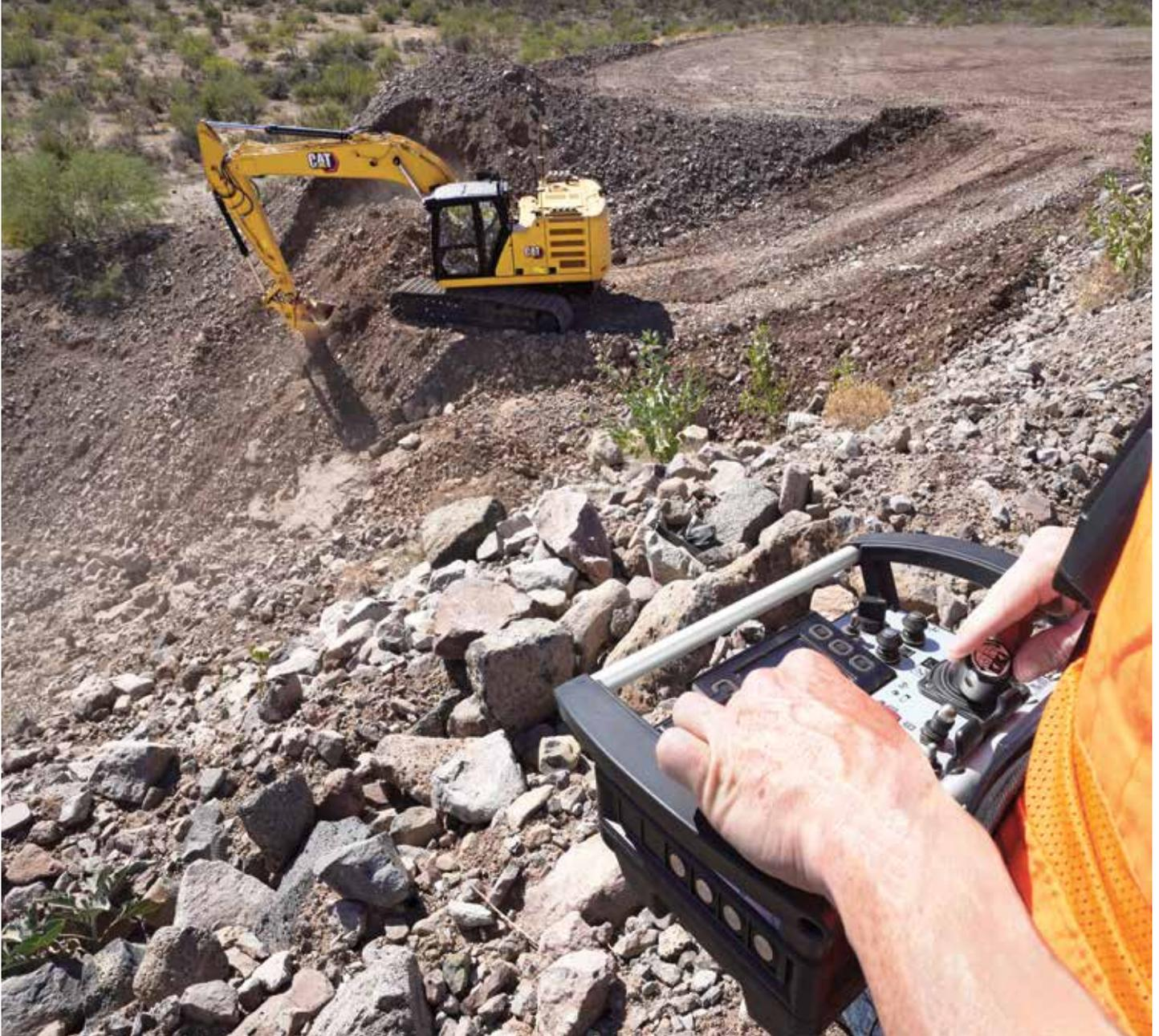
Los controles de la consola Cat Command y la estación Cat Command están totalmente integrados en los sistemas hidráulicos y electrónicos de la máquina.
