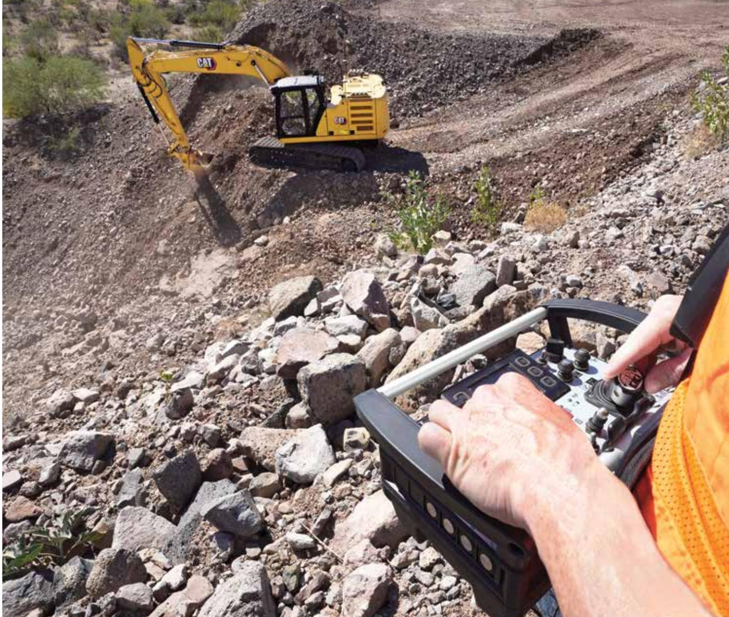
I comandi di Cat Command Console e Cat Command Station sono completamente integrati nei sistemi elettronici e negli impianti idraulici della macchina.
