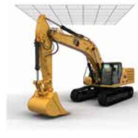
电子墙壁限高
