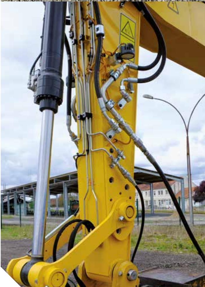
Der M323F ist werksseitig mit der gesamten Hydraulik ausgestattet, die für bahnspezifische Werkzeuge erforderlich ist. Die serienmäßige Zusatzhydraulik (einschließlich Hochdruckkreis) sowie Schnellwechslerleitungen und -kreise ermöglichen einen einfachen Wechsel der Anbaugeräte, ohne dass zusätzliche Hydraulikleitungen an Ihre Maschine angeschlossen werden müssen.
