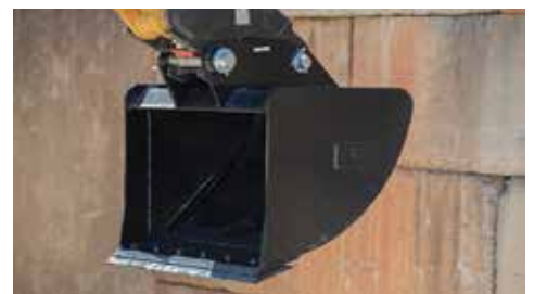
3 Tonnen Erdaushublöffel (Friedhof)
