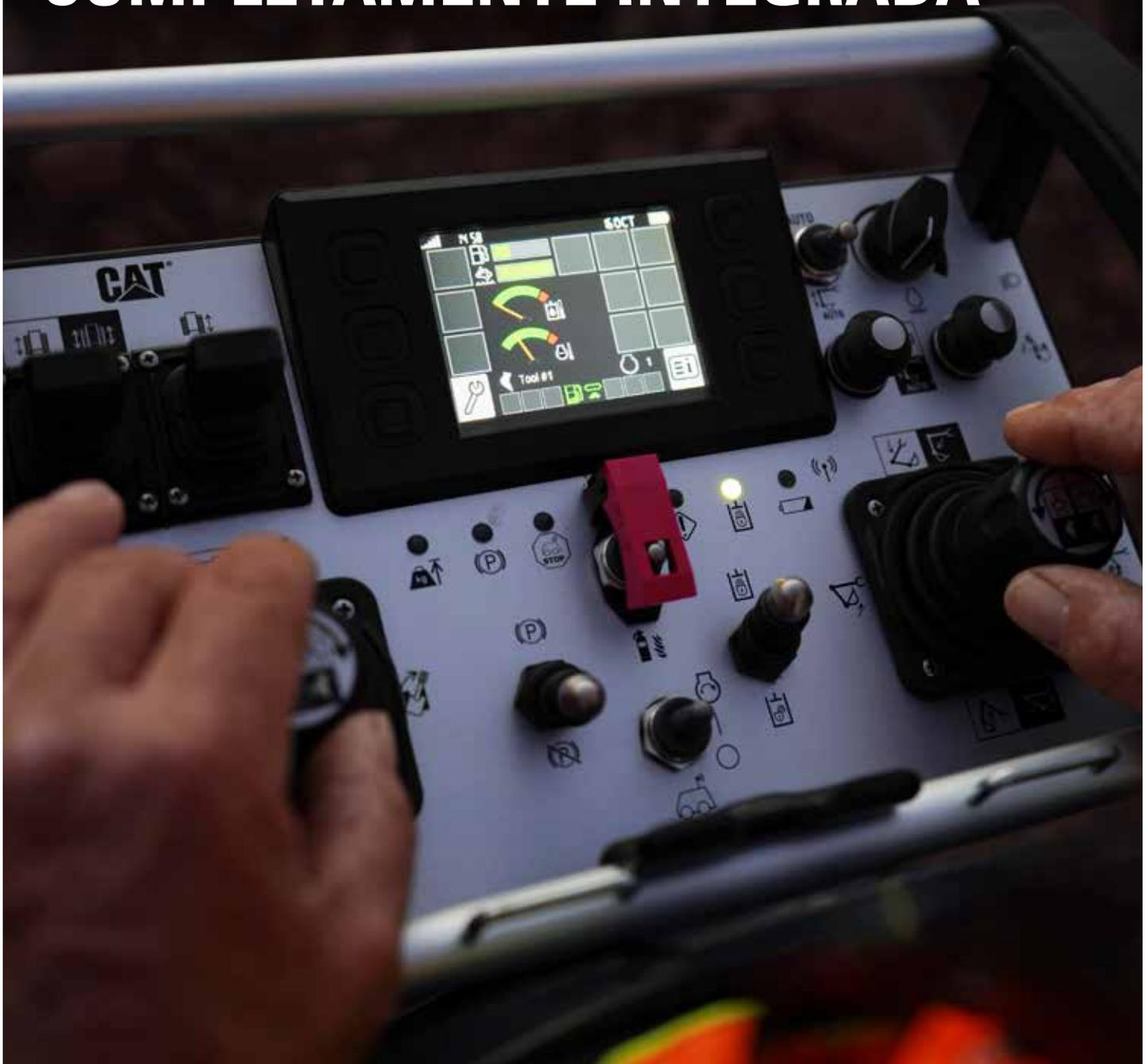
Los controles de la consola y la estación Cat Command están completamente integrados en los sistemas hidráulico y electrónico de la excavadora.
