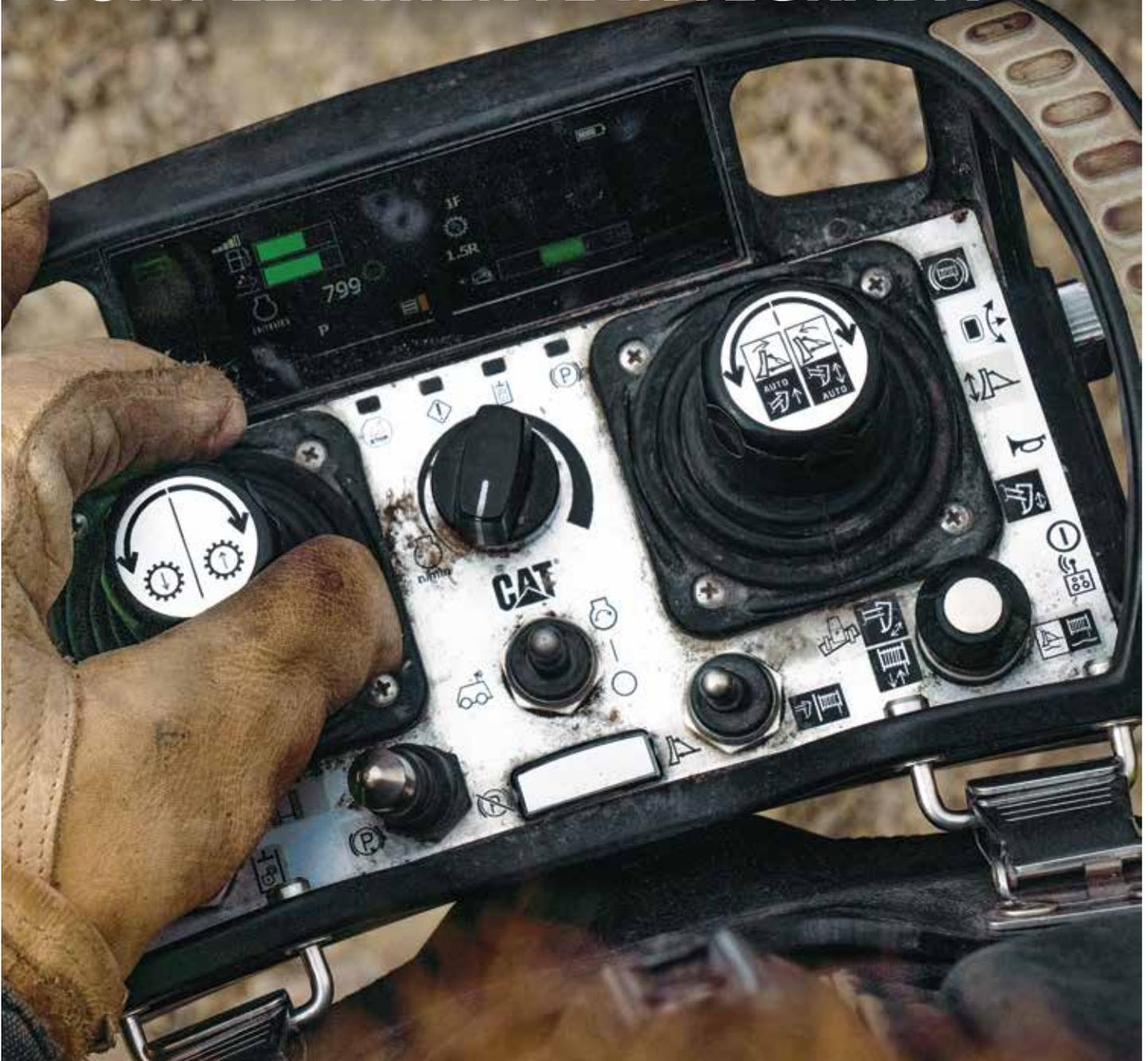
Los controles de la consola y la estación Cat Command están completamente integrados en los sistemas hidráulico y electrónico de la hoja de empuje.
