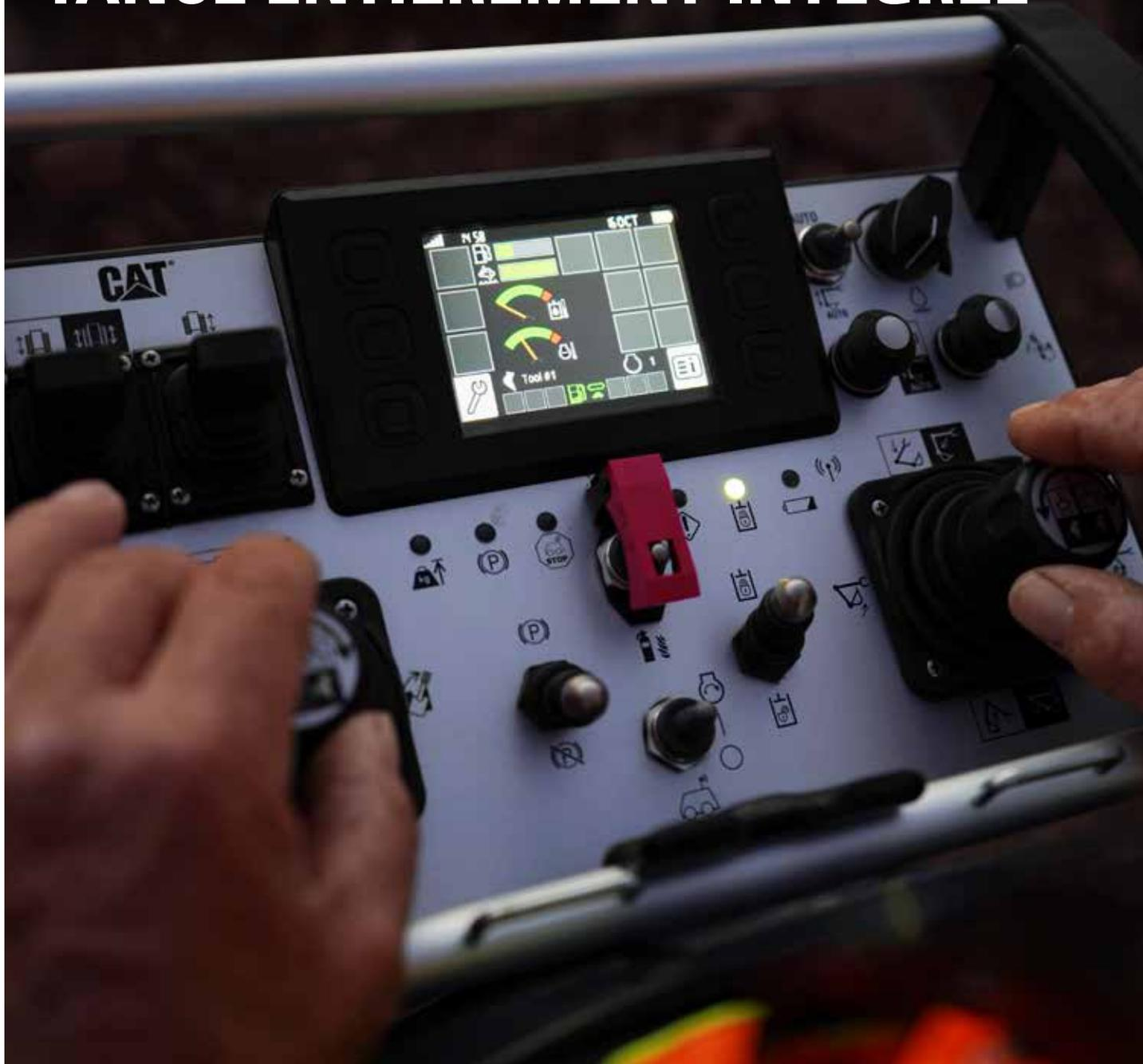
Les commandes Cat Command Console et Cat Command Station sont entièrement intégrées aux systèmes électroniques et hydrauliques de la pelle hydraulique
