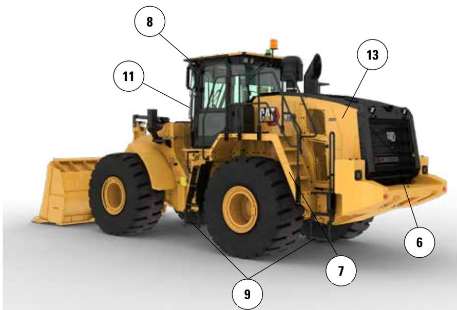
6. Interruptores de parada del motor y anulación del freno de estacionamiento a nivel del suelo.
