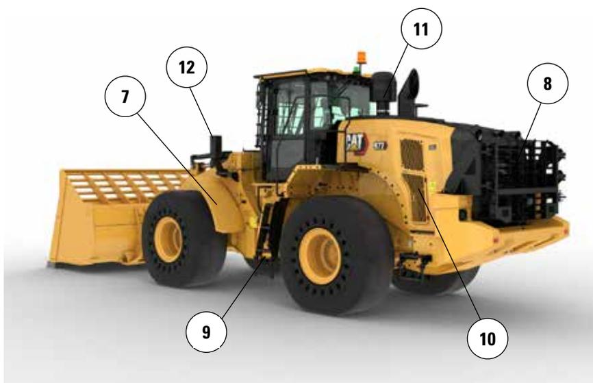
7. Los guardabarros delanteros estrechos de acero ayudan a mantener el parabrisas limpio y se colocan en el interior del borde exterior del neumático para una mayor protección.
