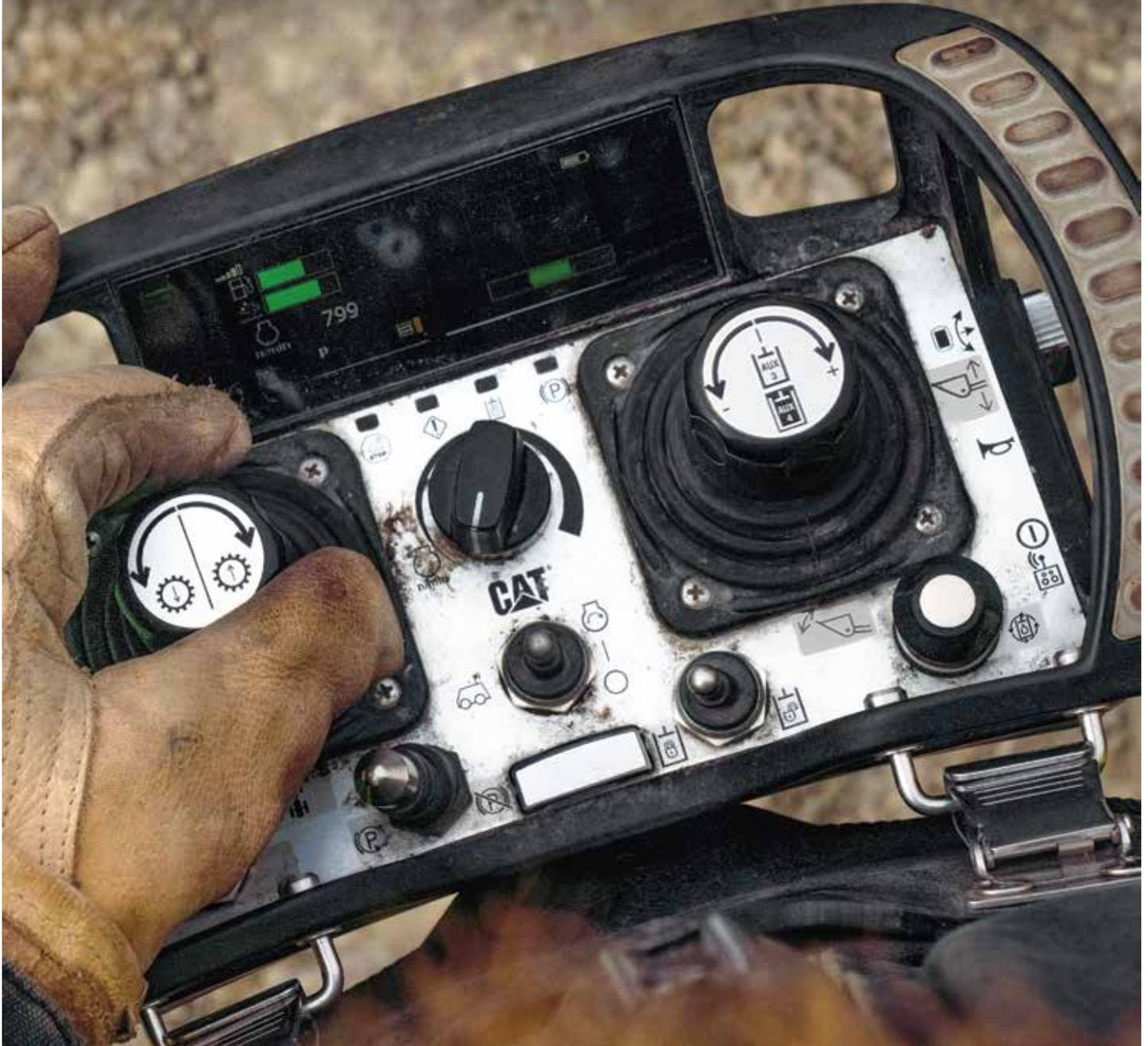
Les commandes Cat Command Console et Cat Command Station sont entièrement intégrées aux systèmes électroniques et hydrauliques de la chargeuse sur pneus.
