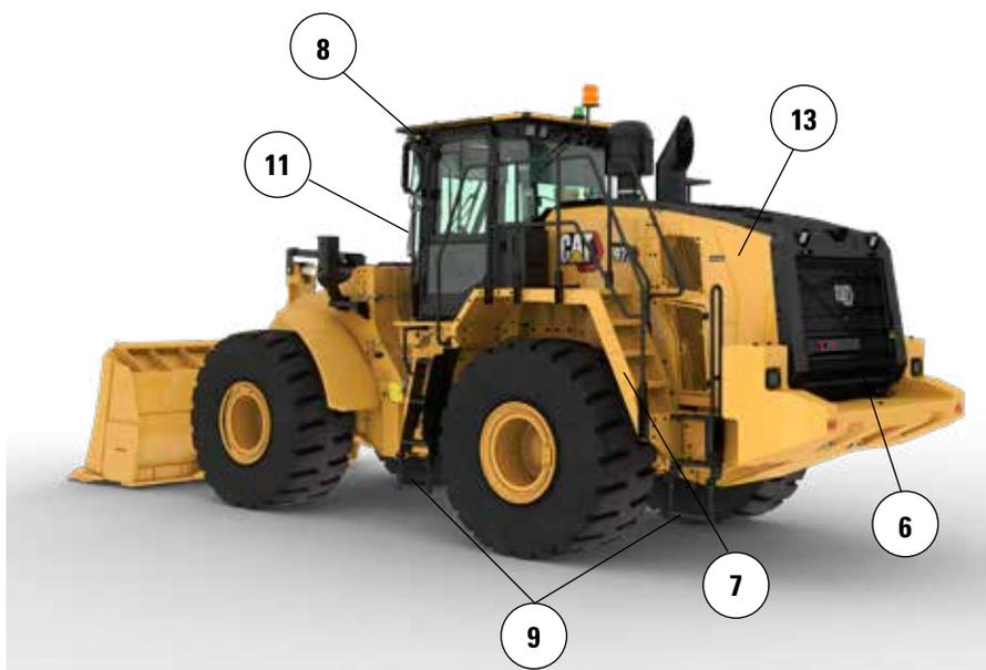
6. Contacteur de neutralisation du frein de stationnement et d'arrêt du moteur au niveau du sol
