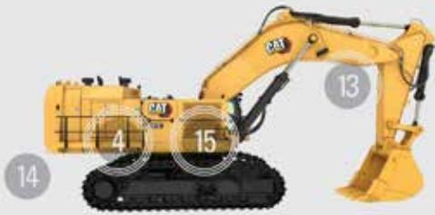
1. Rangka carbody dan crawler yang kokoh dengan undercarriage HD, roller HD, idler HD, track HD, dan penegang track Cat®
