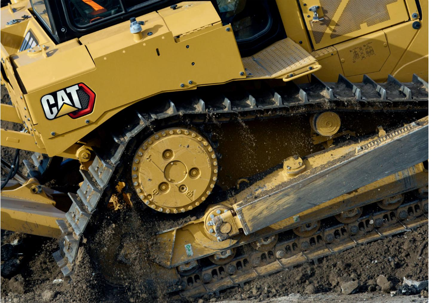
الهيكل السفلي الخاص بالمهام الصعبة، مع الجنزير المشحّم مدى الحياة، وبكرات الحامل ووحدات التباطؤ، هي مكونات قياسية في D6R2. تم تصميم المكونات لإطالة عمر التآكل في أوضاع العمل الكاشطة أو التأثير العالي مثل الغابات أو المنحدرات الجانبية أو العمل في التضاريس الصخرية.
