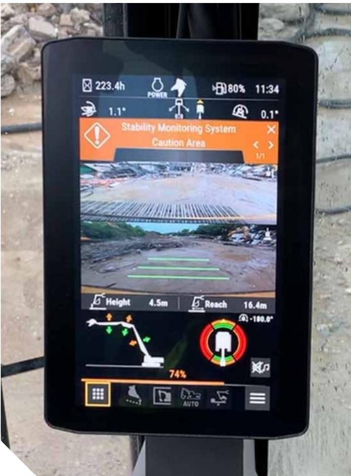
El sistema monitor de estabilidad Cat para las máquinas con pluma delantera de UHD le permite estar al tanto de la posición del accesorio dentro de la gama de trabajo segura. El sistema controla la posición de la parte delantera y el ángulo de giro. Los indicadores audibles y visuales advierten al operador cuando se acerca al límite de estabilidad.
