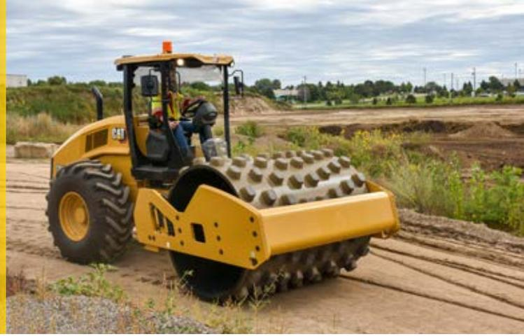
توفر ضوغط التربة الاهتزازية Cat® CP11 GC التوازن بين التشغيل السهل، وتكاليف التشغيل المنخفضة، وتقنية تعزيز الأداء في موقع العمل. وباستخدام نظام اهتزازي مؤكد الكفاءة تم تصميمه لضمان الموثوقية العالية، فإن بكرة الأقدام البارزة CP11 GC مناسبة بشكل مثالي للاستخدامات في التربة المتلاصقة وشبه المتلاصقة.
