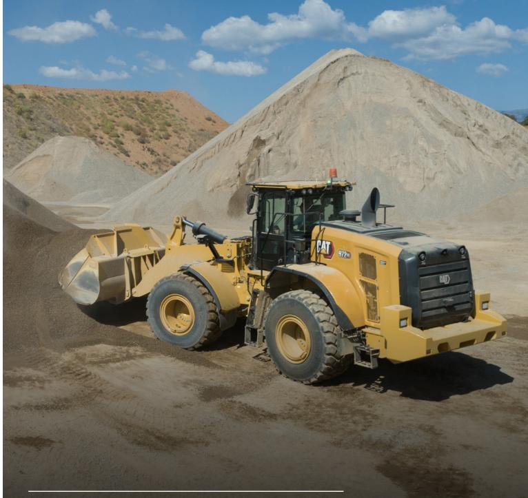
Puissance maximale du moteur Poids en ordre de marche 253 kW (339 hp) 24 890 kg (54 858 lb)
