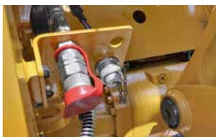
Les circuits hydrauliques auxiliaires sont disponibles avec des raccords à enfoncer à ou à visser pour le raccordement de vos équipements à vos équipements Cat Work Tools préférés. Les commandes des outils électriques depuis la cabine offrent des options uniques lorsque cela est nécessaire.
