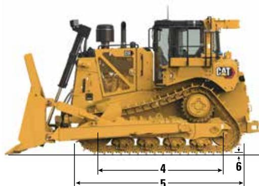
• Poids en ordre de marche - Standard : inclut les commandes hydrauliques, le vérin d'inclinaison, le liquide de refroidissement, les lubrifiants, le plein de carburant, la cabine ROPS/FOPS, l'ensemble pour traitement des déchets, la lame semi-universelle pour traitement des déchets, le caisson de décrottage, les patins de 610 mm (24 in) pour service intensif et le poids du conducteur.
