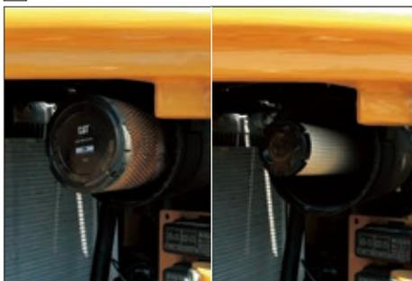
ラジアルシール式エアフィルタをダブルで使用しています。目詰まりが一目でわかるインジケータ付です。
