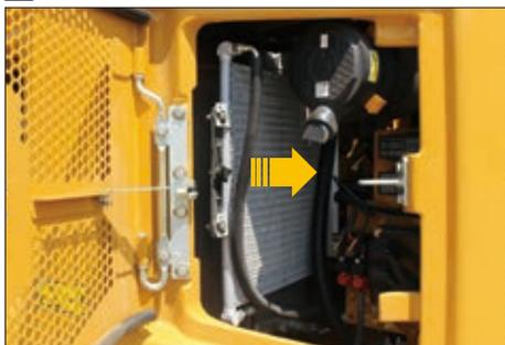
工具なしで横開きできるスイングタイプエアコンコンデンサにより、ラジエータ、オイルクーラの清掃が容易に行えます。
