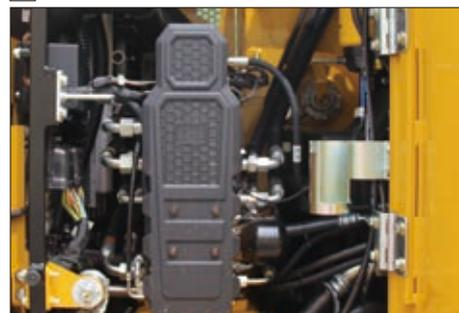
周辺にスペースを確保し、アクセス、整備が容易に行えます。樹脂カバーを装着し、外部の衝撃からバルブを保護しています。
