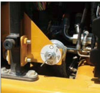
電気系統のON/OFFが行えるディスコネクトスイッチを装備しています。電気系統整備時の安全性を確保します。
