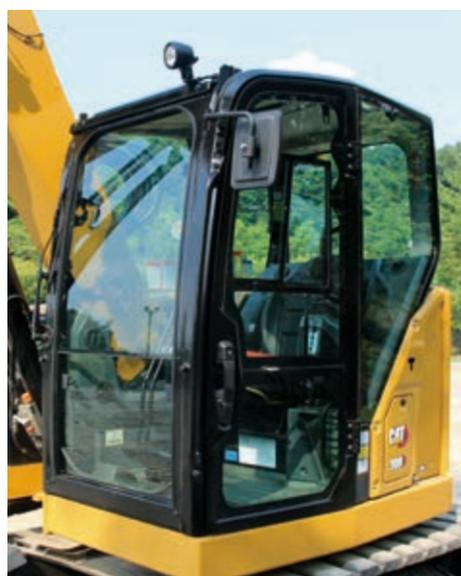
油圧ショベルの転倒時運転者保護構造 (ISO 12117-2) 規格に適合したROPSキャブを搭載。
