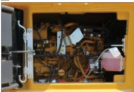
エンジン周りの日常点検、定期整備箇所へアプローチしやすく、エンジンファンガードが作業時の安全を確保します。
