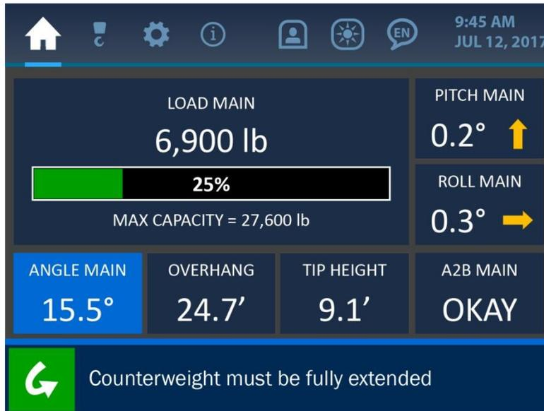
Abbildung 2-10: Home-Bildschirm mit hervorgehobener Winkelanzeige
