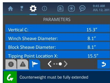
Abbildung 6-6b: Parameter-Menü für Rohrverleger (2)
