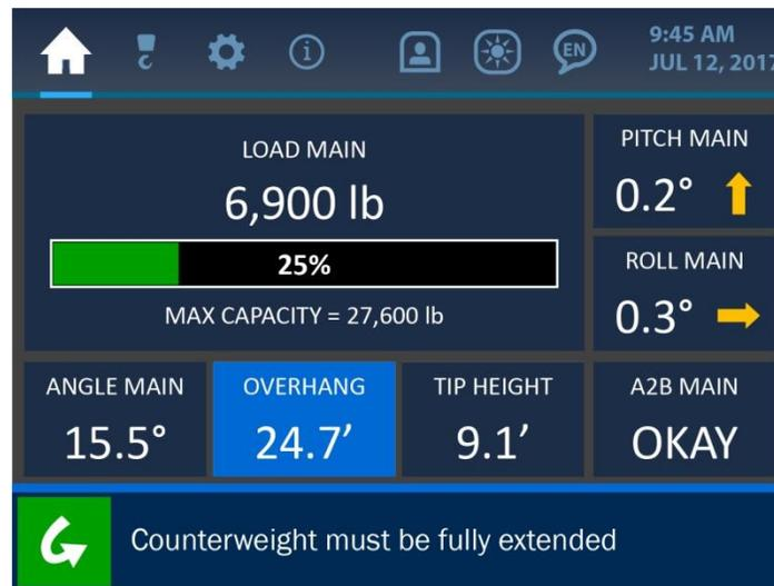
Abbildung 2-16: Home-Bildschirm mit hervorgehobener Auskragungsanzeige
