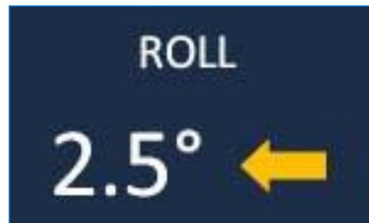
Abbildung 2-26b: „Invertierte“ Ausrichtung des Rollwinkelparameters für einen Rollwinkel von  $2,5^\circ$  nach rechts
