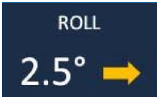
Abbildung 2-26a: „Normale“ Ausrichtung des Rollwinkelparameters für einen Rollwinkel von  $2,5^\circ$  nach rechts
