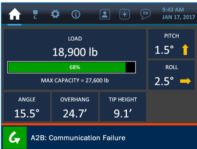
Abbildung 10-3: Kommunikationsfehler mit einer Komponente
