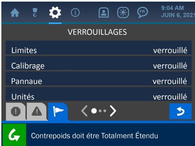
Figure 6-8a : menu Verrouillages Superviseur 1
