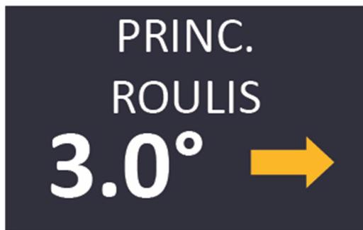
Figure 2-26a : orientation « Normale » du paramètre Roulis, montrant un roulis vers la droite de 3°
