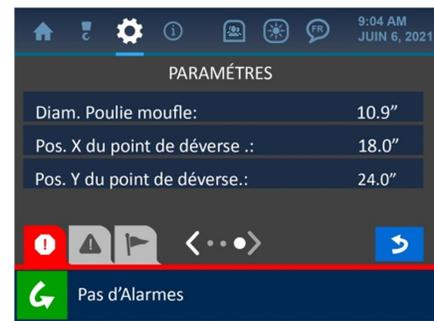
Figure 6-6c : menu 3 des paramètres du pose-canalisation
