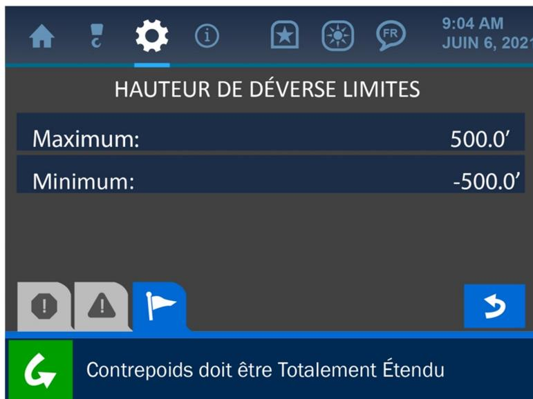
Figure 2-20 : menu Limites de la hauteur de l'extrémité
