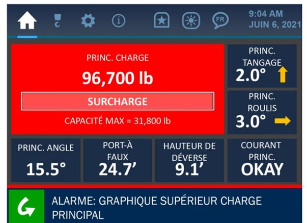
Figure 10-2 : écran d'alarme de charge
