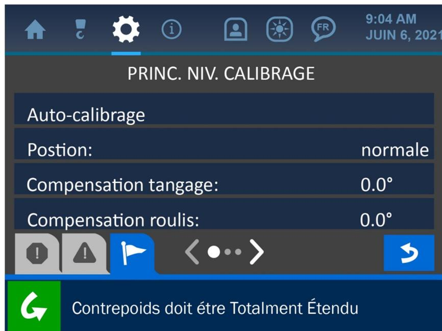
Figure 2-24 : menu Calibrage du niveau
