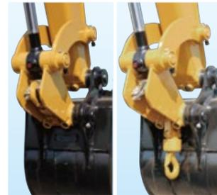
フックの出し入れがワンタッチで簡単に行えるラッチ格納式を採用しています。
