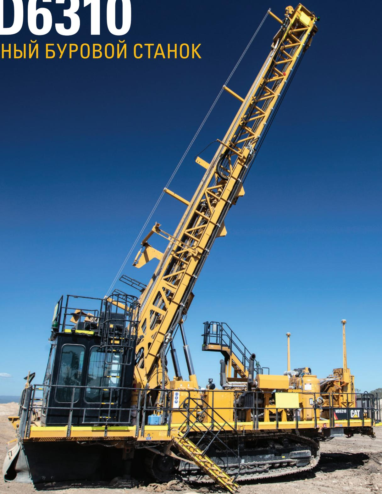
Нагрузка на долото: До 42 149 кг (92 922 фунта)
