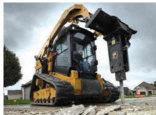
Marteaux : Chargeuses compacts rigides, pelles hydrauliques, minipelles hydrauliques, pelles hydrauliques sur pneus et chargeuses-pelleteuses
