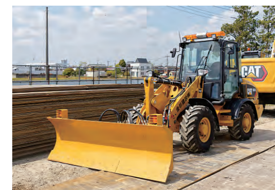
豪雪時の緊急対応に備えて資材センターで出番を待つ907Mホイールローダ(道路維持作業車)。
