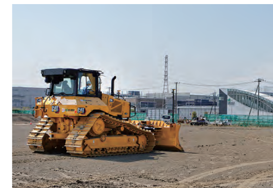
ニュータウン開発の盛土工事に活躍する次世代型D5ブルドーザ。右奥に見えるのがJR武蔵野線吉川美南駅。
