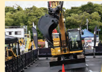
屋外ブースで実演を行う次世代油圧ショベル315 with チルトローテータ。左右のチルトと360°旋回により、勾配のある現場などで車両が傾いた状態でも、任意の角度で作業が可能です。
