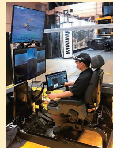
会場に設置したCatコマンドステーションで米国アリゾナ州にある油圧ショベル320の遠隔操作をライブ実演。
