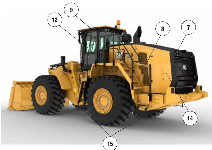
7. Interruptores de desligamento do motor e de neutralização do freio de estacionamento no nível do solo
