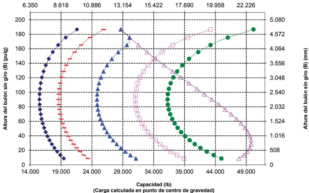
**NOTA:** Las cargas límite de equilibrio estático y el peso de funcionamiento se basan en la siguiente configuración de pala: neumáticos Bridgestone® VLTS L4, aire acondicionado, control de amortiguación, protector del tren de potencia, todos los fluidos, depósito de combustible, refrigerante, lubricantes y operador.
