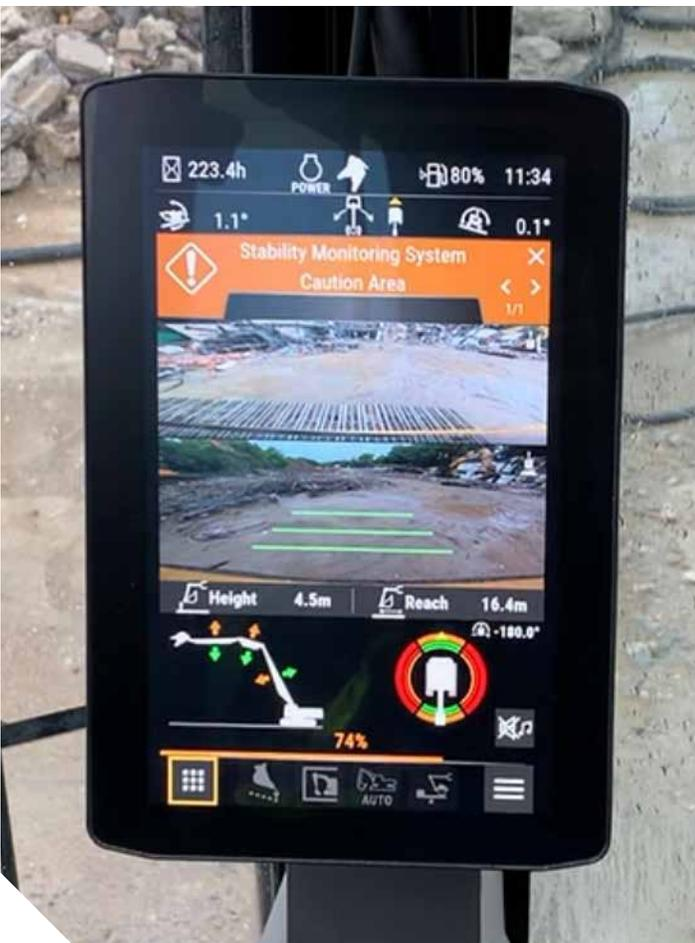
Das Cat-Standsicherheits-Überwachungssystem in Maschinen mit UHD-Arbeitsausrüstung informiert den Fahrer fortlaufend über die Arbeitsgeräteposition im sicheren Arbeitsbereich. Das System überwacht die Position und den Schwenkwinkel der Arbeitsausrüstung. Akustische und optische Signale warnen den Fahrer, wenn er sich der Kippgrenze nähert.
