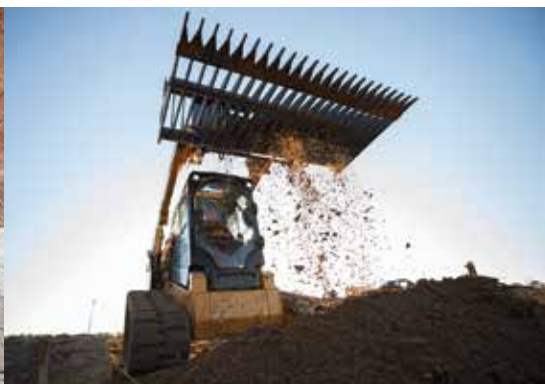
Скелетный ковш с пластинчатыми зубьями
