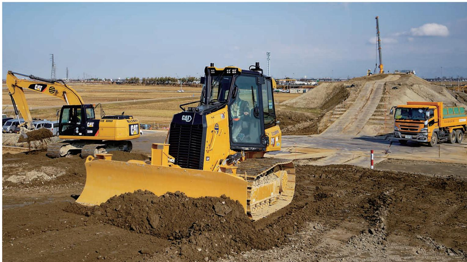
ICT施工により精度の高い敷き均しを実現する次世代ブルドーザD1。
