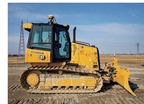
キャブ上にGNSS受信機を取り付けたD1。6月に着工する次の現場では3D施工機として活躍します。
