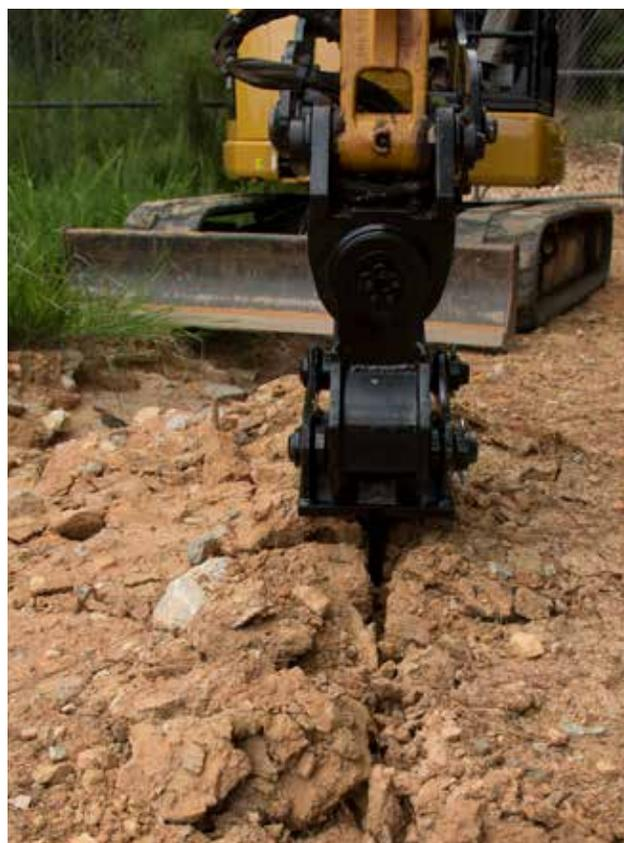
**ACESSÓRIOS XTC (eXtra Tool Carrier) (SOMENTE MÁQUINAS 304.5E2 XTC e 306 XTC)** As miniescavadeiras Cat XTC incluem uma interface de carregadeira de esteiras no lugar da lâmina padrão da escavadeira, proporcionando versatilidade e integração com ferramentas de trabalho usando acessórios de carregadeiras compactas.
