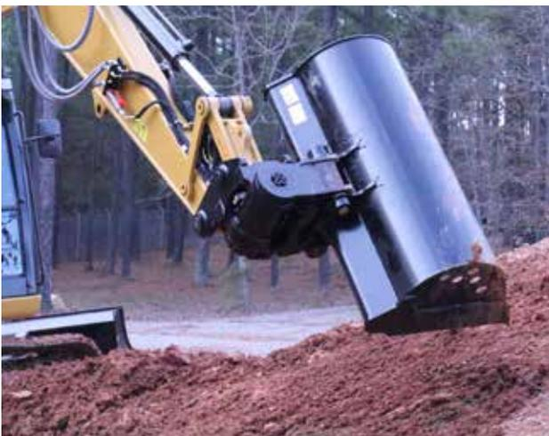
**ACOPLADORES RÁPIDOS HIDRÁULICOS DE INCLINAÇÃO COM TRAVAMENTO DUPLO PINADO**
