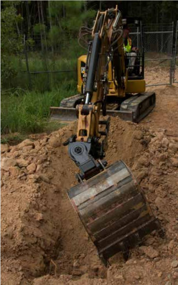
**Os Acopladores com Engate Rápido Cat "Pin Grabber" com Travamento Duplo de Inclinação da Miniescavadeira permitem que as ferramentas de trabalho sejam rapidamente substituídas,** melhorando a produção geral e aumentando a versatilidade da máquina. O Acoplador Dual Lock de Inclinação mantém uma instalação vedada com um projeto de cunha inovador ao longo de toda a vida útil do acoplador. Ele pode ser usado com ferramentas de trabalho pinadas compatíveis e no modo de pá frontal com caçambas.
