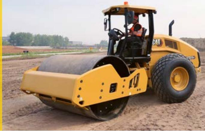
توفر ضو OG التربة الاهتزازية Cat® CS11 GC التوازن بين التشغيل السهل، وتكليف التشغيل المنخفضة، وتقنيات تعزيز الأداء في موقع العمل. وباستخدام نظام اهتزازي مؤكّد الكفاءة تم تصميمه لضمان الموثوقية العالية، فإن البكرة الأسطوانية الملساء CS11 GC مناسبة بشكل مثالي للاستخدامات في التربة الحبيبية أو الأعمال التي تتم في التربة المتماسكة مع استخدام الطقم الاختياري لأغلفة الأقدام البارزة.
