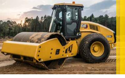
Le modèle CS10 GC Cat® comporte un cylindre lisse et convient parfaitement aux applications sur sols granulaires ou aux applications sur sols cohésifs avec l'utilisation d'un kit de bandage pour pieds dameurs en option.
