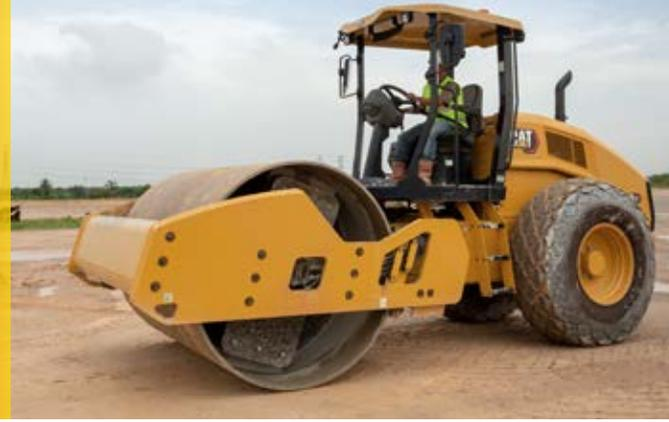
توفر ضوغط التربة الاهتزازية Cat® CS10 GC التوازن بين التشغيل السهل، وتكاليف التشغيل المنخفضة، وتقنية تعزيز الأداء في موقع العمل. وباستخدام نظام اهتزازي موكد الكفاءة تم تصميمه لضمان الموثوقية العالية، فإن البكرة الأسطوانية الملساء CS10 GC مناسبة بشكل مثالي للاستخدامات في التربة الحبيبية أو الأعمال التي تتم في التربة المتماسكة مع استخدام الطقم الاختيارية لأغلفة الأقدام البارزة.
