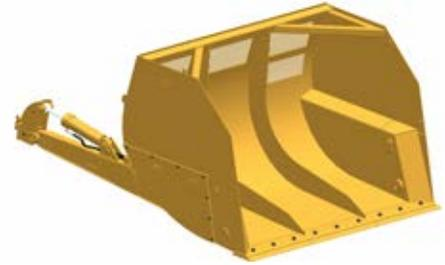
تتوفر كلا المغرفتين بأسطوانتي رفع لزيادة قدرة الرفع. يضمن جهاز التثبيت المدمج أن تظل المغرفة ثابتة وفي وسط الماكينة. تتوفر وظيفة إمالة المغرفة كخيار قياسي ويمكنها الإمالة بمقدار  $\pm 15$  درجة للمحافظة على ظروف التسوية وتأمين عملية التشغيل.
