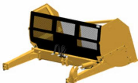
チップ用スコップには、リフト能力の向上のためにリフトシリンダが装備されています。一体型スタビライザシステムによって、スコップが安定して車両の上にとどめられます。スコップのチルト機能が標準装備されており、±15度の傾斜を提供して、グレードの状態を維持し、安全に作業できるようにします。
