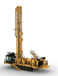
Sondeuse rotative avec configuration de mât de 13,7 m ou 17,5 m (44,9 ft ou 57,4 ft)
