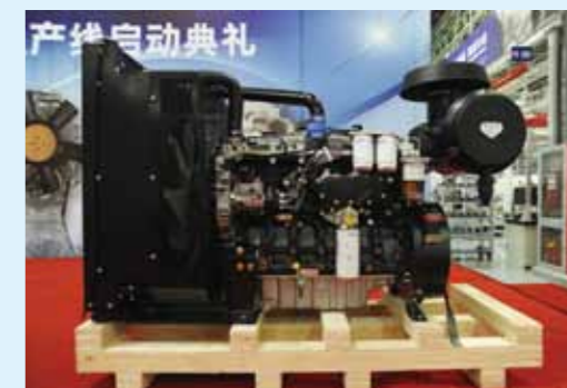
无锡首台下线的1106A发动机,此系列甫投产即已获得几百台订单。
