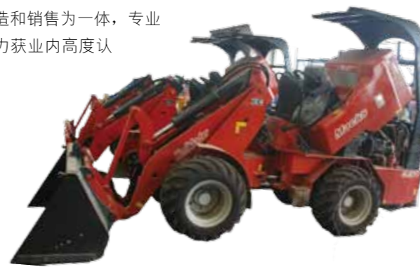
▲ 厦工微型装载机装配Perkins 403D发动机。
