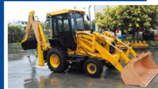
XG778G高原型挖掘装载机（配套Perkins 1104C-44TA型号发动机）是厦门厦工机械股份有限公司专为高原恶劣环境而设计的工程机械产品。整机适用于海拔4000米的低压缺氧、低温、辐射强、风沙大的恶劣环境中作业。该产品主要攻克了动力系统功率下降、冷却散热系统、低温缺氧启动等多项技术难点，是国内首款专为高原地区设计制造的挖掘装载机。获得2013年度中国工程机械产品“TOP50”殊荣，实至名归。
