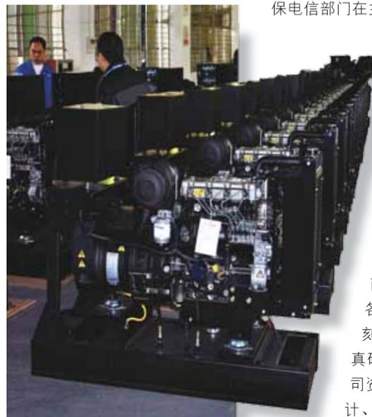
恢复通电。再加上优良的底座材料以提高减震效果，有效减小机组噪音。
