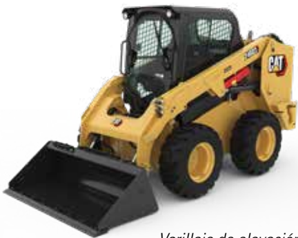
Varillaje de elevación radial
