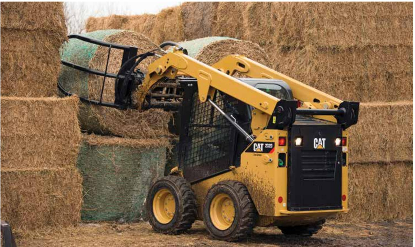
Los **arpones para fardos** están diseñados para cargar y acarrear materiales enfardados redondos y cuadrados. Se pueden transportar fardos de trigo, heno y otros materiales para alimento, cama para ganado, etc. Con óptima rigidez y capacidad, las herramientas de arpón para fardos están diseñadas para tener una larga vida útil.
