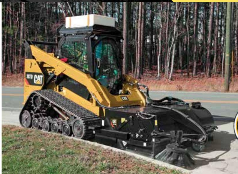
Los **cepillos recogedores** barren y depositan materiales en una tolva integrada para una fácil remoción y descarga.
