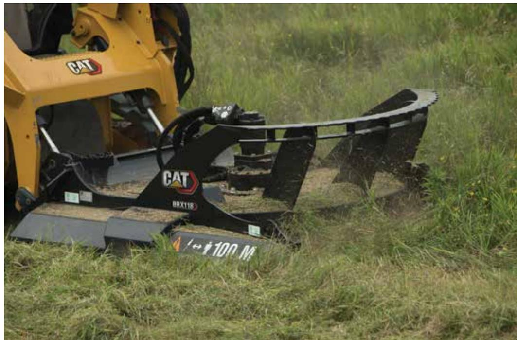
Los **cortadores de maleza** se usan para desmontar el crecimiento excesivo de vegetación en las medianas de carreteras, facilitar el servicio y llevar a cabo el desmonte inicial en terrenos para viviendas, parques y áreas recreativas.
