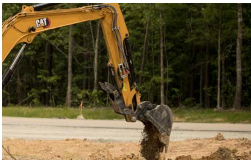
La forma de los cucharones Cat mejoran la excavación, la carga y retención de material. Cada cucharón está hecho de acero templado de alta resistencia. Elija de una variedad de dientes de cucharón.
