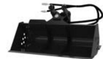
**CUCHARÓN PARA LIMPIEZA DE ZANJAS CON INCLINACIÓN Y CON PASADOR**
